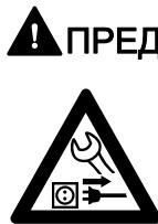
Преди започване на каквото и да било дейности по уреда: изваждайте щепсела за свързване с електрическата мрежа от контакта.
