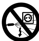
Никога не пръскайте електрически съоръжения, връзки и електропроводи с високонапорната струя или с маркуча за вода – **опасност от късо съединение!**
