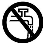
Visokotlačni čistač se ne smije direktno priključivati na opskrbnu mrežu s vodom za piće.
