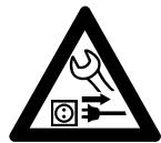
Pred vsakim delom na napravi: izvlecite omrežni vtič iz vtičnice.
