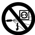
Elektromos berendezéseket, csatlakozókat és elektromos vezetékeket ne fröcsköljön le magasnyomású vízsugárral vagy a víztömlőben lévő vízzel – **Rövidzárlat veszélye!**
