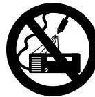
Jak vlastní stroj, tak ani jiné elektrické spotřebiče nikdy neostřikovat vysokotlakým proudem nebo vodní hadicí – **hrozí nebezpečí zkratu!**
