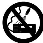
Magát a berendezést és más elektromos készülékeket soha ne fröcskölje le a magasnyomású vízsugárral vagy a víztömlőből kifolyó vízzel - **Rövidzárlat veszélye!**
