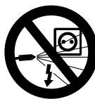
Električnih naprav, priključkov in električnih napeljav nikoli ne škopite z visokotlačnim curkom ali z vodno cevjo – **nevarnost kratkega stika!**
