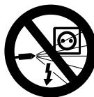
Електрични инсталации, приклучоци и проводници под напон не смеат да се прскаат со млаз под висок притисок или со црево за вода – **опасност од краток спој!**
