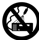
Sam uređaj i druge električne uređaje ne prskajte mlazom pod visokim pritiskom ili crevom za vodu – **opasnost od kratkog spoja!**
