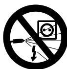
Električna postrojenja, priključke i vodove pod naponom ne prskajte mlazom pod visokim pritiskom ili crevom za vodu – **opasnost od kratkog spoja!**
