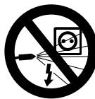
Nie spryskiwać strumieniem wody pod wysokim ciśnieniem lub wodą z węża instalacji elektrycznych, przyłączu lub przewodów pod napięciem — **zagrożenie wystąpieniem zwarcia!**
